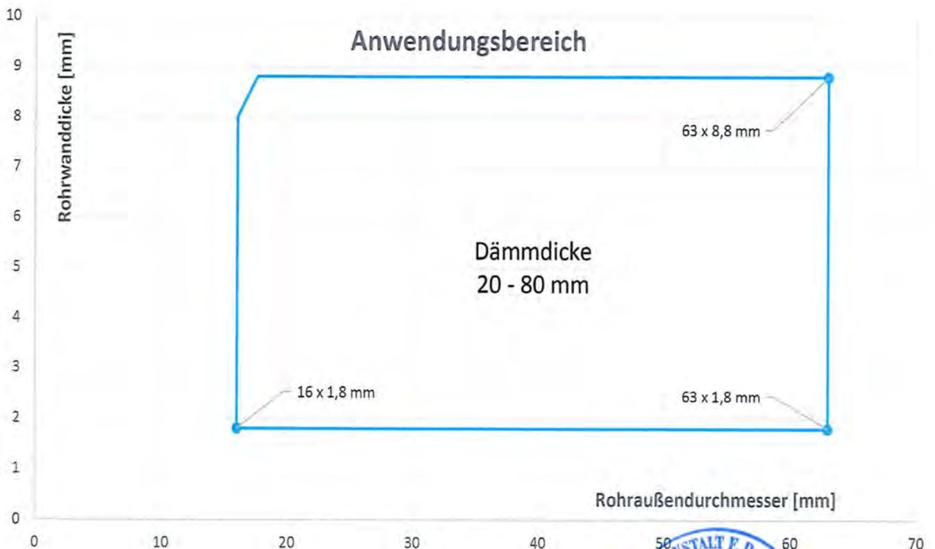
**Rohrabschottung „ISOVER U Protect Pipe Section Alu2 für brennbare Rohrleitungen“**
