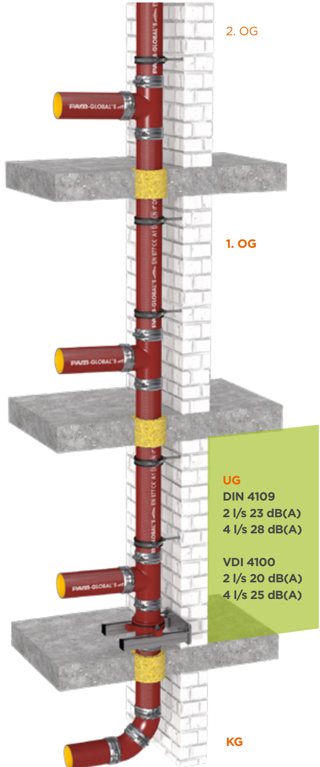
Detailansicht UG: Standardbefestigung mit TYRODUR Rohrschelle
