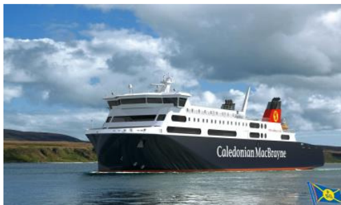
Bild 1 (Quelle: FSG): Die 116 m lange „Loch Seaforth“ befördert bis zu 700 Passagiere sowie 143 Pkw oder 20 Lkw.
